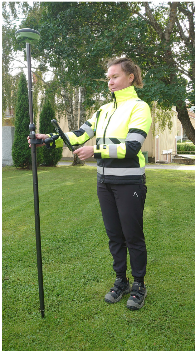
Från 2024 utförs byggnadsinspektionens utpålningar med GNSS-mottagare. Rakennustarkastuksen paalutukset tehdään v. 2024 lähtien GNSS-vastaanottimella.
