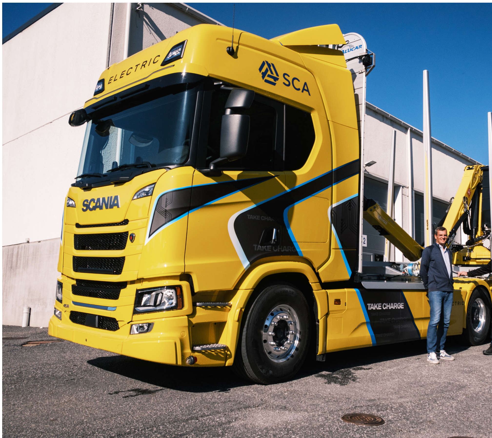
Lastbilen väger 19 ton, varav 3 ton består av batterier. Anssi Alasaari och Thomas Partanen är nöjda med projektet. FOTO: JONNY HUGGARE SMEDS
