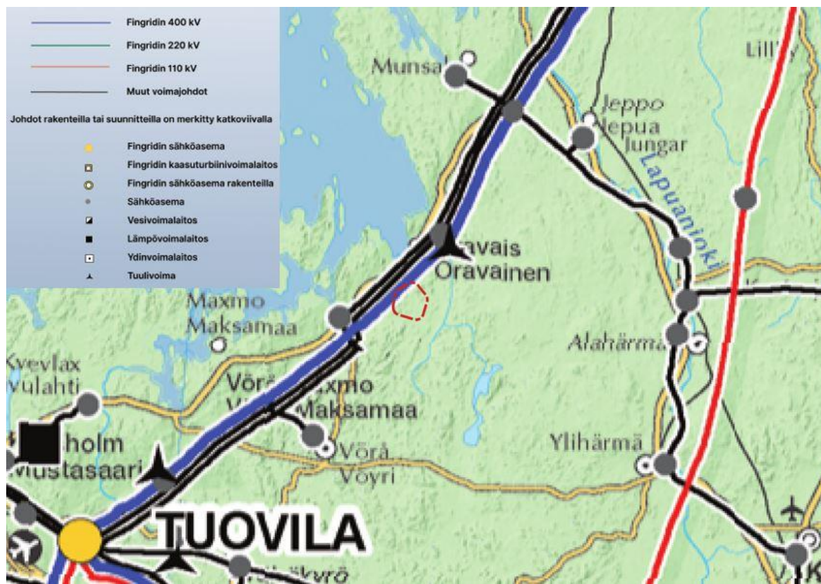
Bild 11. Utdrag ur Finlands elöverföringsnät 2024. 400 kV:s kraftledning anges med blå färg, 110 kV:s kraftledning med röd färg och elstationer med en grå cirkel. Övriga kraftledningar har markerats med svart färg. Ölands planeringsområde har markerats med röd streckad linje i mitten av bilden. ( https://www.fingrid.fi/globalassets/kuvat/kartat/seinakartta-2024-150-dpi-70-x-120-cm.pdf , hämtad 17.9.2024)
